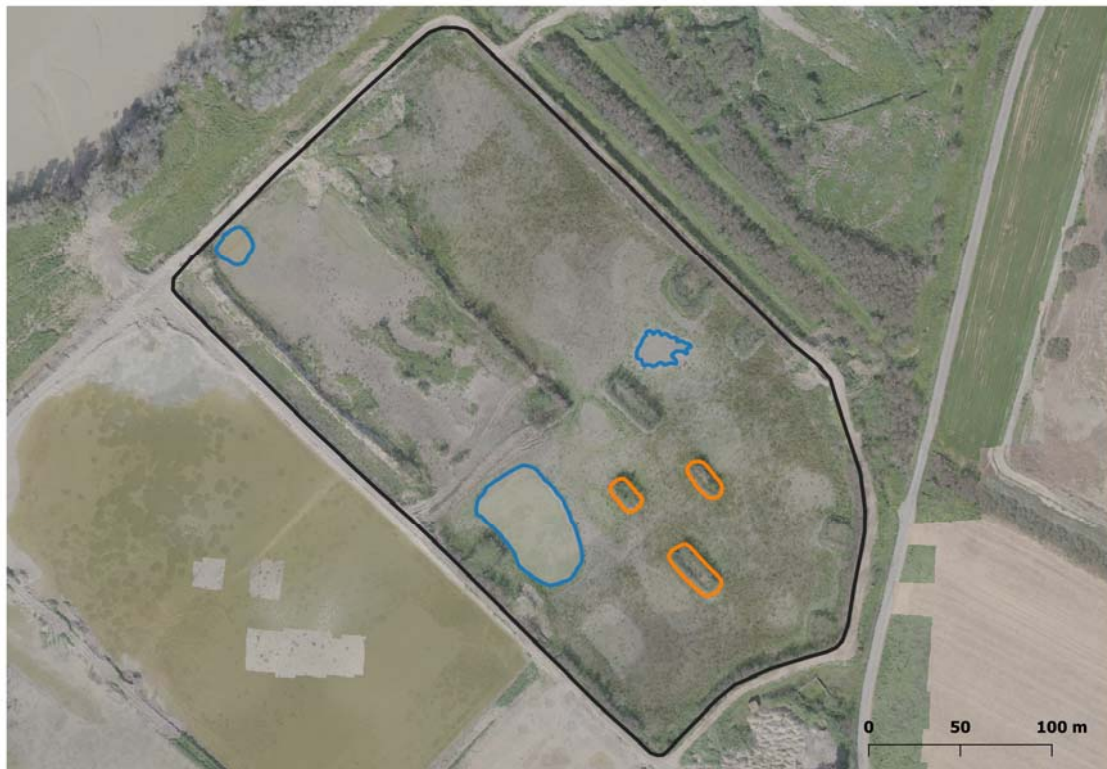
Figura 4. Esquema sobre planta de elementos físicos propuestos (arriba) y situación real de inundación y elementos a mediados de febrero (abajo) en el sector Butano2. Línea negra: coronación de mota perimetral; línea azul: borde de lámina de agua; línea naranja: islas artificiales preexistentes.
