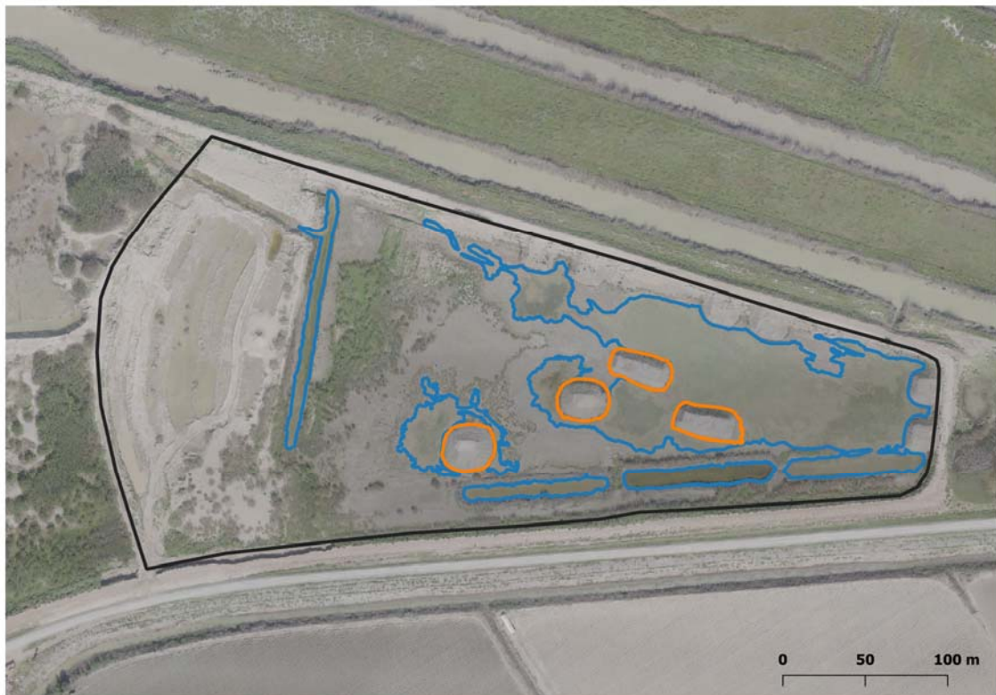
Figura 5. Esquema sobre planta de elementos físicos propuestos (arriba) y situación real de inundación y elementos a mediados de febrero (abajo) en el sector Horcada1. Línea negra: coronación de mota perimetral; línea azul: borde de lámina de agua; línea naranja: islas artificiales preexistentes.
