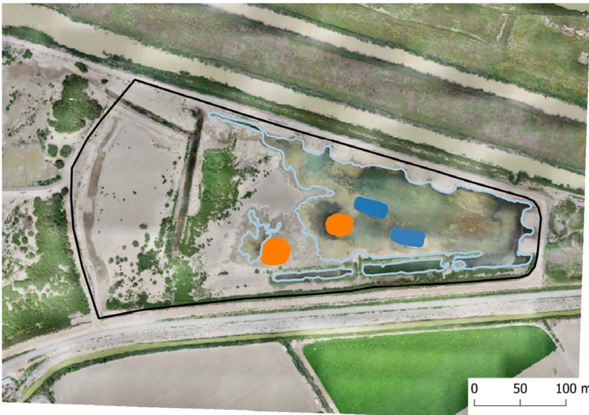
Figura 4. Esquema sobre planta de elementos físicos propuestos (izquierda) y situación real de inundación y elementos a mediados de abril (derecha) en los sectores Horcada1 y 2. En foto derecha, azul claro: borde de lámina de agua, azul oscuro y naranja: islas artificiales.
