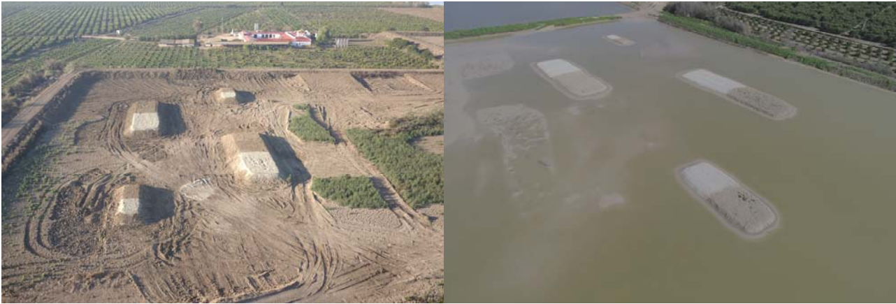
Fotografía 2. Panorámica de las cuatro islas artificiales construidas en la zona S de Butano3S, antes del llenado con el vertido de dragados (izquierda) y después (derecha). Se aprecia la mitad de la superficie de cada isla cubierta con grava (Autores: DRAVO.S.A.; M. Barbero, AerialRotors)
