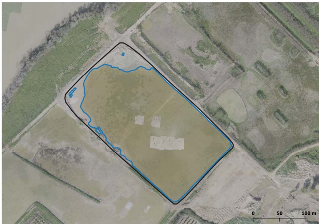
Figura 2. Esquema sobre planta de elementos físicos propuestos (arriba) y situación real de inundación y elementos a mediados de febrero (abajo) en el sector Butano3N. Línea negra: coronación de mota perimetral; línea azul: borde de lámina de agua.
