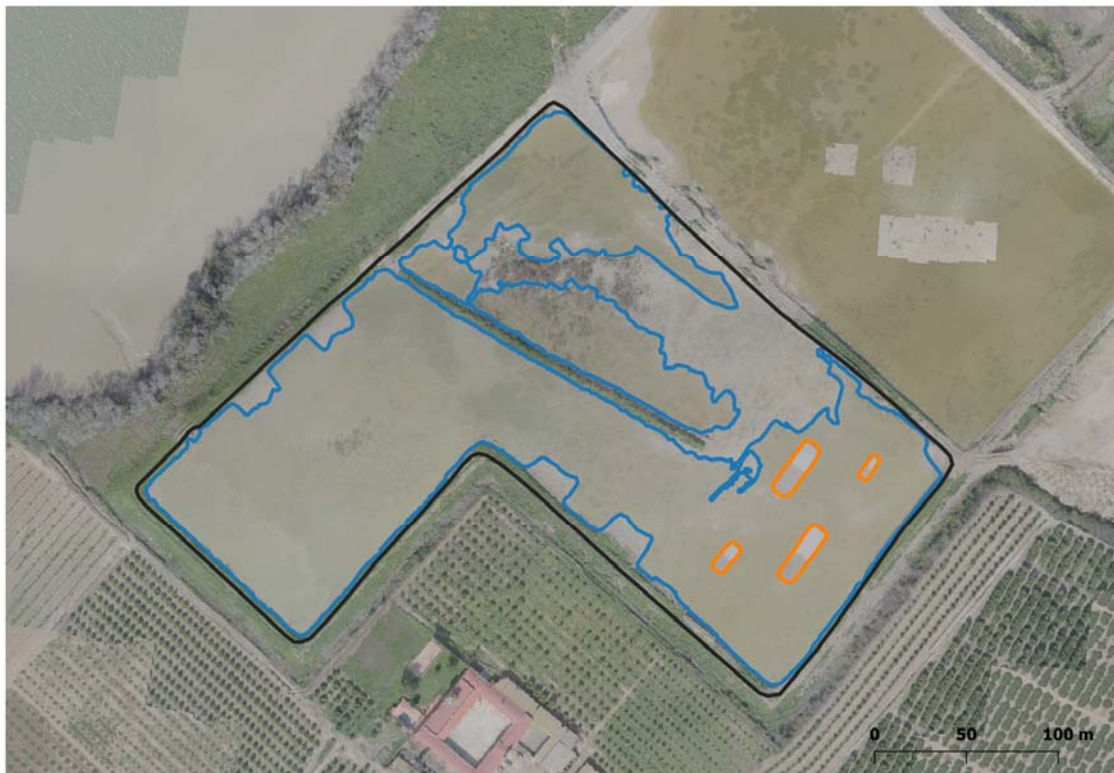
Figura 3. Esquema sobre planta de elementos físicos propuestos (arriba) y situación real de inundación y elementos a mediados de febrero (abajo) en el sector Butano3S. Línea negra: coronación de mota perimetral; línea azul: borde de lámina de agua; línea naranja: islas artificiales construidas.
