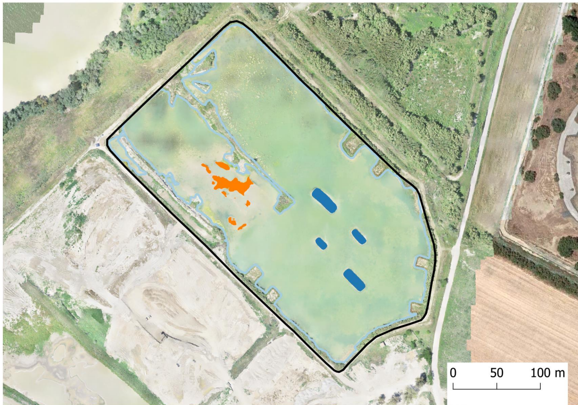
Figura 3. Esquema sobre planta de elementos físicos propuestos (izquierda) y situación real de inundación y elementos a principios de mayo (derecha) en el sector Butano2. En foto derecha, azul claro: borde de lámina de agua, azul oscuro: islas artificiales, naranja: islotes espontáneos.
