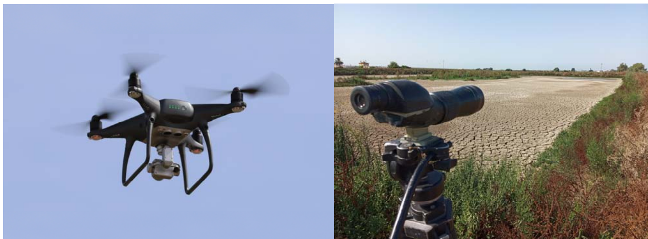
Fotografía 2. Dron Phantom 4 Pro durante vuelo de mapeo en el vaciadero de la Horcada, para la elaboración de ortomosaicos , MDE y material audiovisual (izquierda). Telescopio terrestre sobre trípode en Butano3S, una de las principales herramientas de observación durante los censos de aves (derecha) (Autor: R. Muriel, EBD-CSIC).
